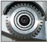
La **rueda perf** que viene estándar con todas las máquinas COUNT tiene 33 dientes o 9 cortes por pulgada.
