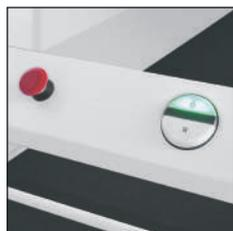
**1** Sencilla operación con el interruptor multifunción EASY-SWITCH que incluye señales ópticas para mostrar el estado de la máquina.
