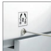
**6** Ajuste rápido de profundidad de cuchilla mediante tornillo lateral.
