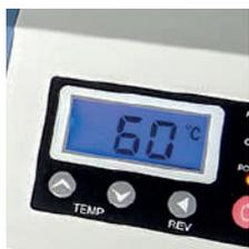
**1** Regulador de temperatura en la pantalla LCD, que nos indica la temperatura que se alcanza, incluso cuando disminuye.
