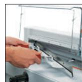
**3** Cambio rápido de cuchillas sin desmontar la carcasa.
