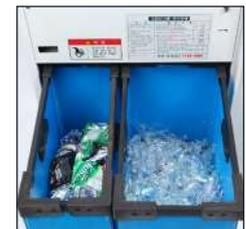
**3** Contenedor separado en dos papeleras para una fácil clasificación del material triturado reciclable.
