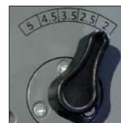
4 Ajuste del margen de posición del taladro en 5 posiciones.
