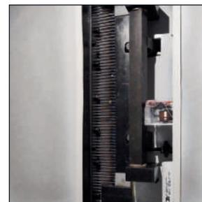
**3** Sistema de empuje por balancín, reforzado para que no se produzca rotura en caso de atasco.
