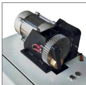
**1** Robusto motor con sistema de seguridad de parada por sobrecalentamiento. Juego de piñones totalmente metálico y piñón de nylon tratado, que actúa sobre ataque de motor para la protección del mismo.
