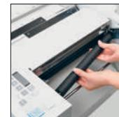
Rodillos de liberación rápida para facilitar el mantenimiento y limpieza.
